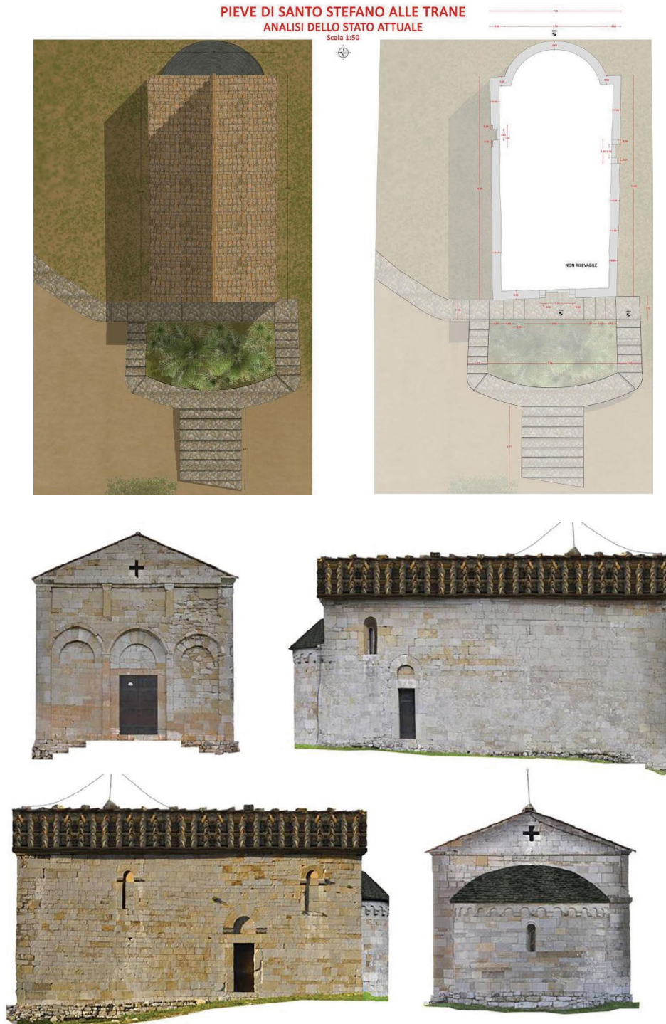
Figura 21. Santo Stefano alle Trane veduta dei prospetti (in ordine: PP1, PP2, PP4 e PP3) pianta e ortofotopiani realizzati da Isabella Trifirò, Irene Costantino e Matteo Grassini della facoltà di Ingegneria dell'Università di Pisa.
