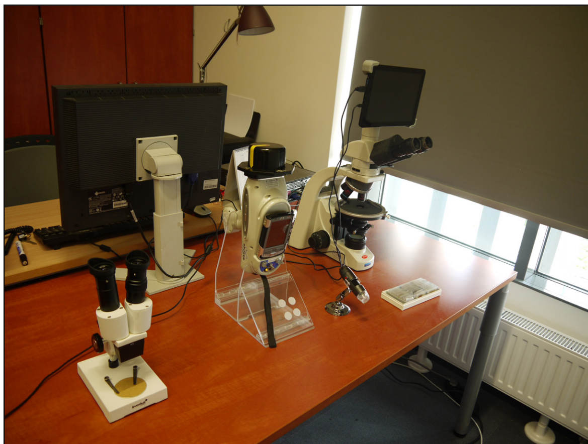
Figure 4. Installation de laboratoire avec loupe binoculaire, spectromètre portable de fluorescence de rayons X, microscope numérique portable et microscope à lumière polarisée (photographie de M. Krueger).
